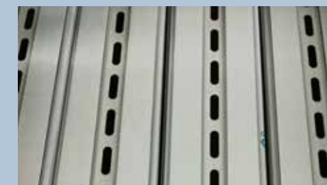
U-Profil Boden und Decke beklebt mit Schaumstoffklebeband
