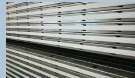
Pfostenprofil beklebt mit Schaumstoffklebeband
